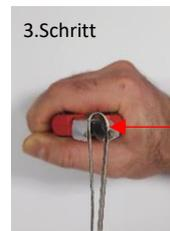
Achtung! Beim Biegen ist darauf zu achten, dass die Öse nicht mehr als 6mm beträgt, damit ein guter Kontakt zur Anodenstange gewährleistet ist.
