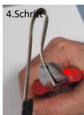
Am Ende der Anodenhalterung wird nochmals eine Biegung gebogen, damit die Anode besser auf die Anodenstange eingeführt werden kann.
